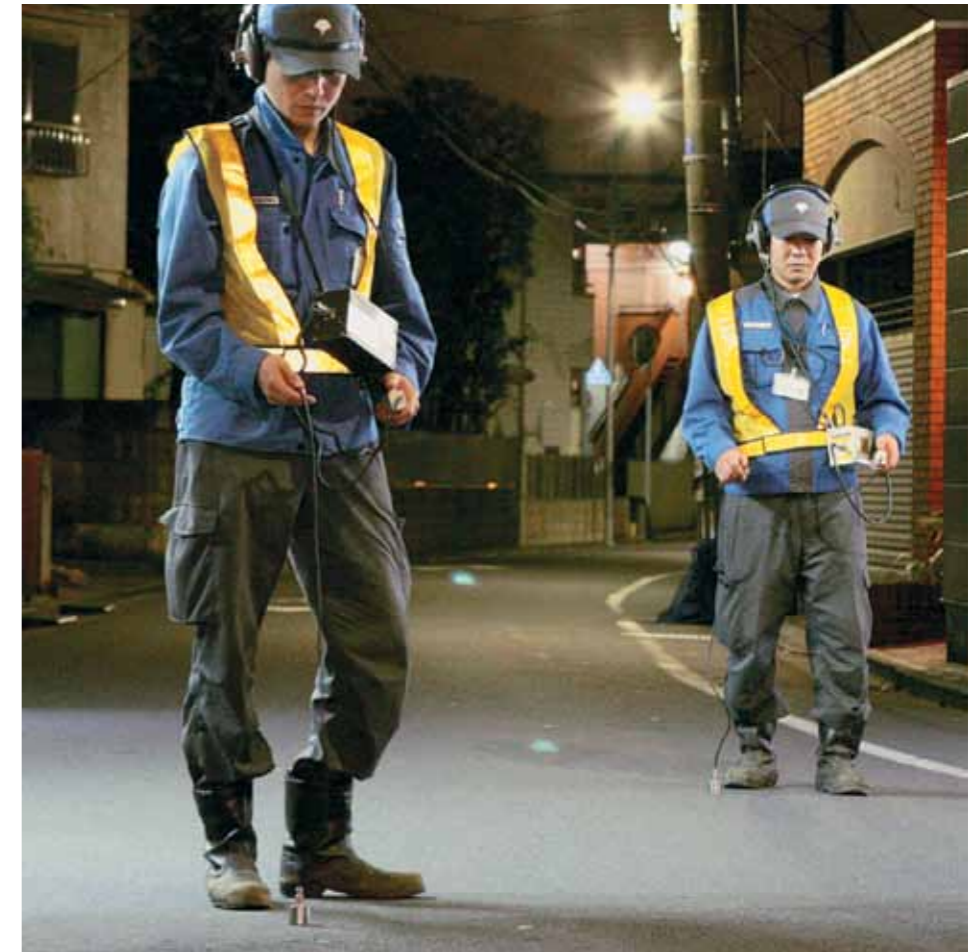
Techniciens utilisant tiges d'écoute et détecteurs électroniques
